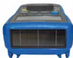
Unidad de recarga solar
